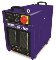
Аппарат плазменной резки LGK160 изготовлен по улучшенной инверторной технологии IGBT. Аппарат характеризуется точным управлением с обратной связью и постоянным током резки. Ток резки легко повышается с 20А до максимально возможного (в зависимости от типа обрабатываемой детали, толщины и необходимой скорости резки).
